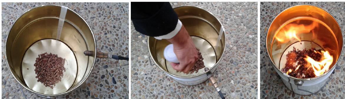
Figura 5.17: Montagem do teste com combustão de pellets numa lata
