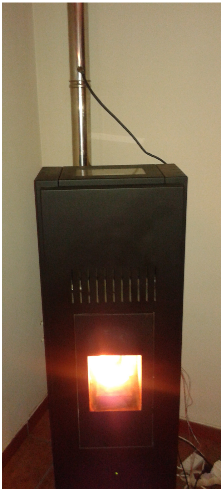
Figura 5.22: Montagem do teste com combustão de pellets numa caldeira
