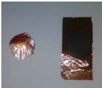
Figura 3.13- Foto representativa da degradação dos filmes crescidos pelo método de arrastamento depois do estudo a temperatura variável.
