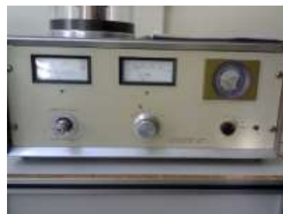
Figura 2.17 – a) e b) Equipamento usado para a deposição do eletrodo de ouro sobre as amostras.
