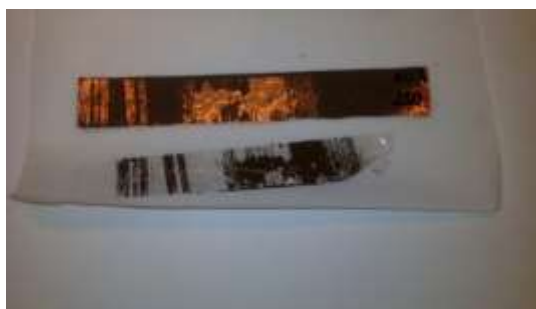
Figura 3.8- Teste de adesão, realizado em Bratislava, para a amostra de 60%.
