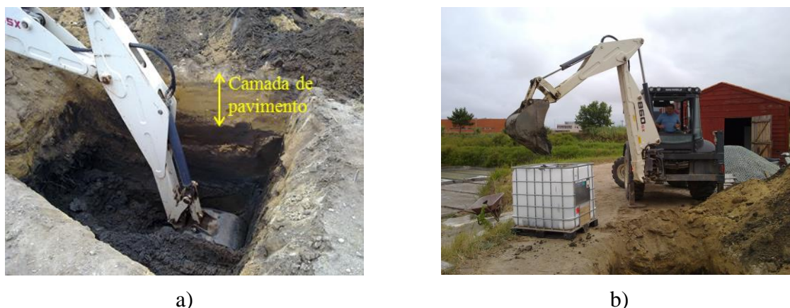
Figura 6.2. Processo de recolha do solo fino: a) poço de recolha; b) equipamento usado para a recolha e armazenamento do solo
