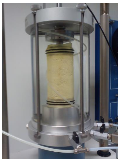
Figura 7.2. Provetes de solo granular usado nos ensaios triaxiais ( D = 70 mm) antes do ensaio
