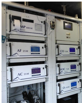
Figura 8 – Analisadores de poluentes presentes no interior do LabQAr.
