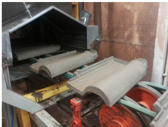
Figura 3.13 - Engobagem das telhas
