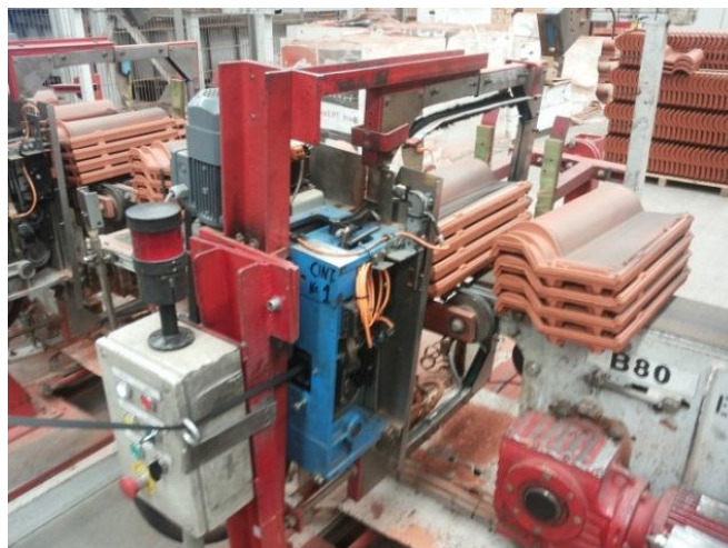
Figura 3.16 - Processo de paletização
