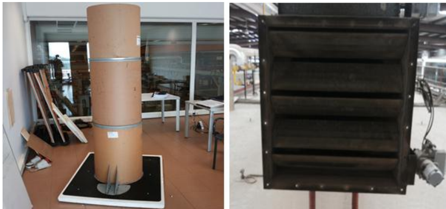
Figura 4.6 - Conduta desenvolvida na CS - Coelho da Silva, S.A. para determinar o caudal de ar novo no pré-forno
