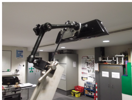
Figura 3.4: Estrutura de suporte da câmara
