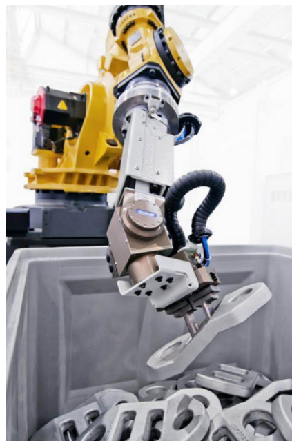
Figura 2.5: Sistema de bin picking da Liebherr Automation [6]
