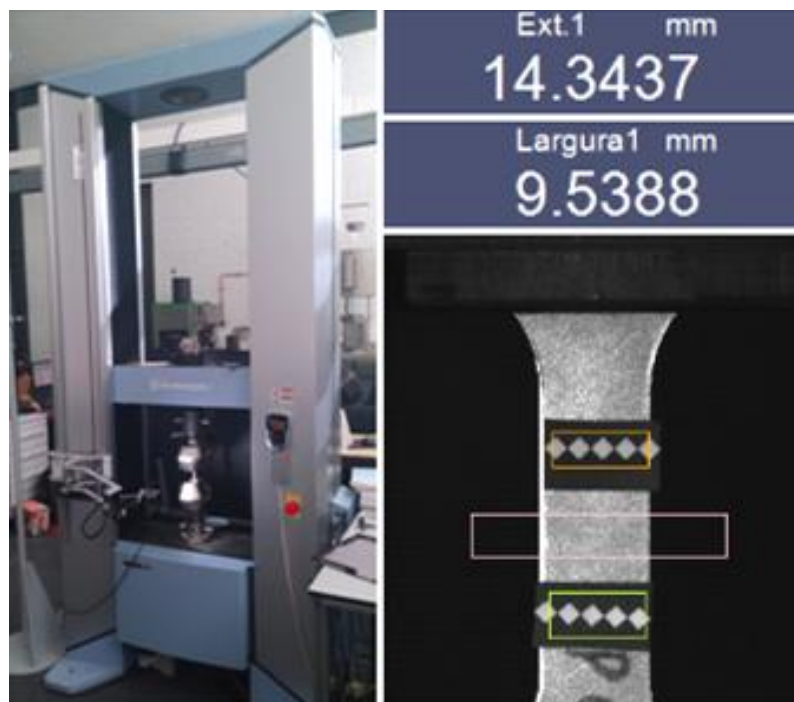
Figura 3.6 - Teste de tração realizado na máquina Shimadzu AG-X plus 100 kN
