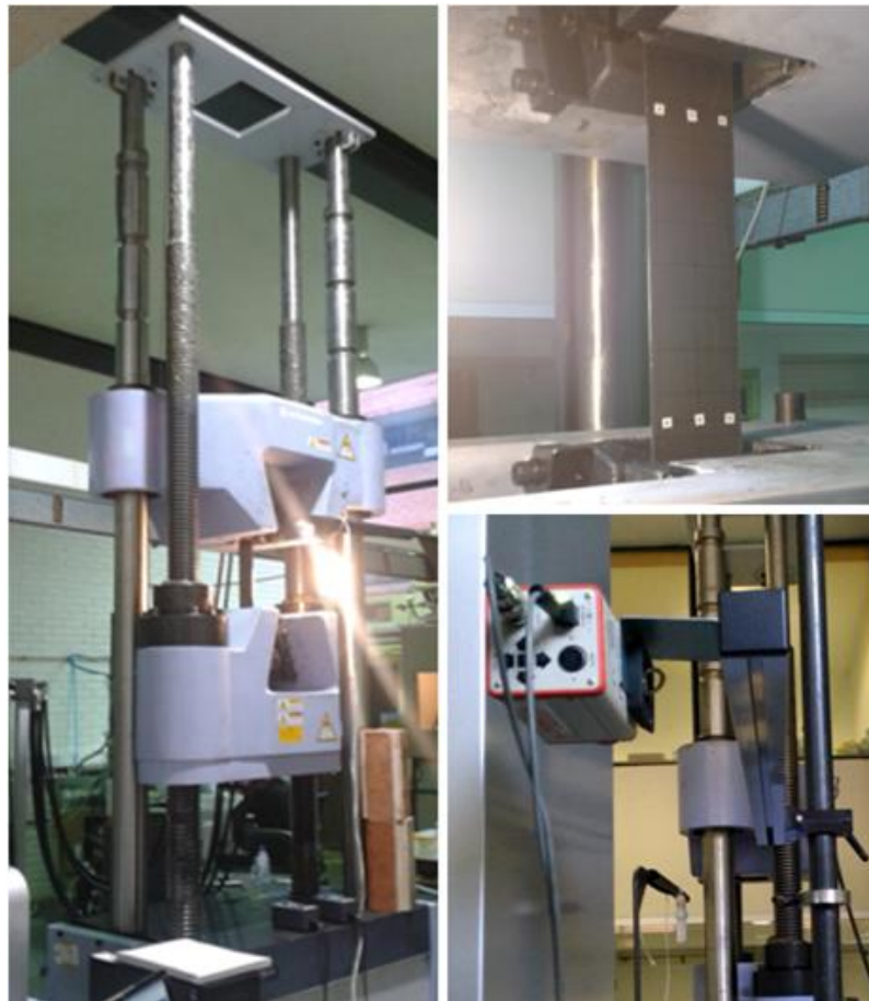
Figura 3.3 - Teste de tração realizado na máquina Shimadzu UH-1000 kN X
