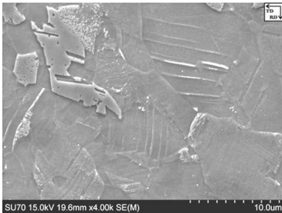
Figura 5.20 - Microestrutura da amostra com 30% de deformação, através de MEV
