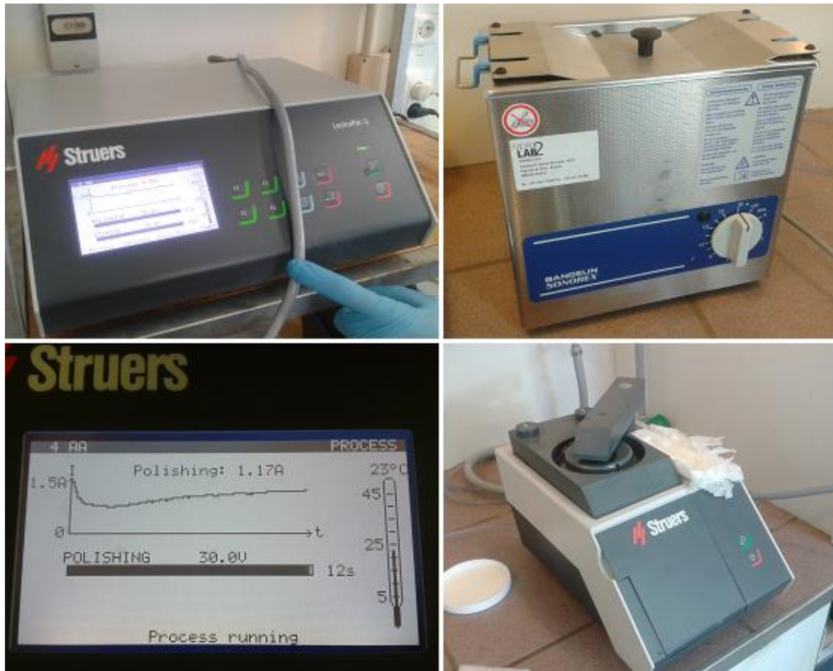
Figura 3.9 - Máquina de polimento eletrolítico LetroPol-5 e de limpeza através de ultrassons
