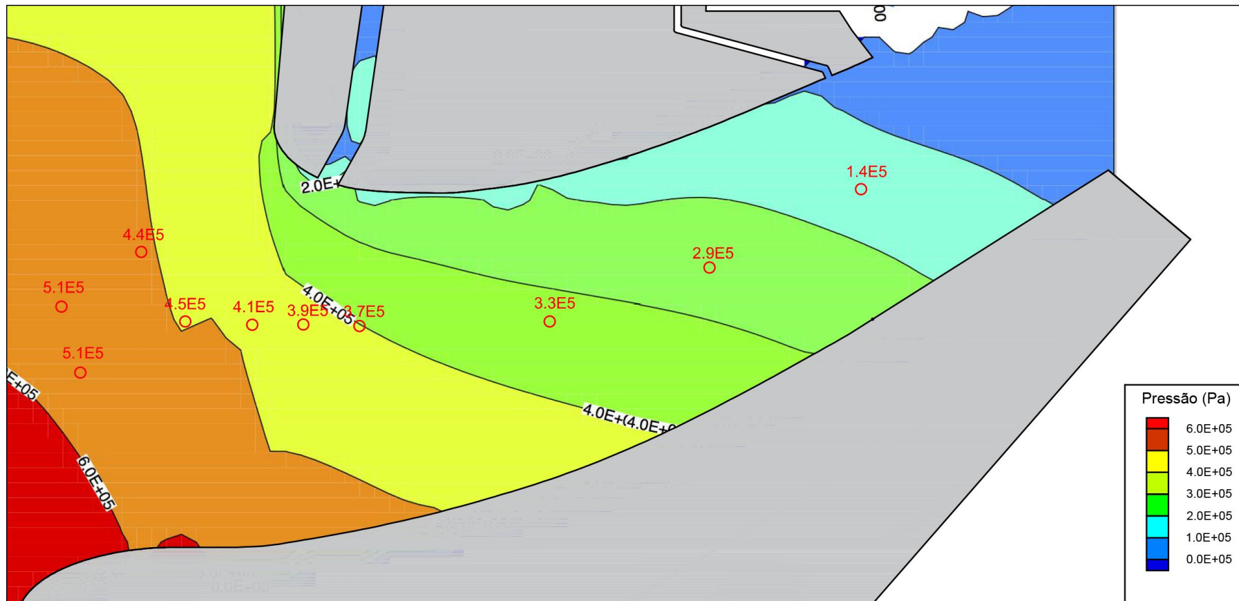
Figura 77 - Comparação dos resultados numéricos e experimentais (a vermelho) para H=300\text{m} - perfil lateral
