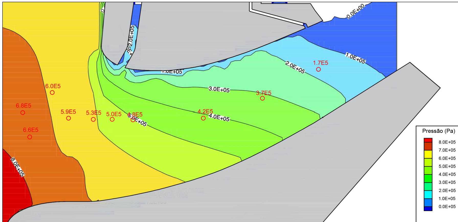
Figura 71 – Comparação dos resultados numéricos e experimentais (a vermelho) para H=320\text{m} - perfil lateral
