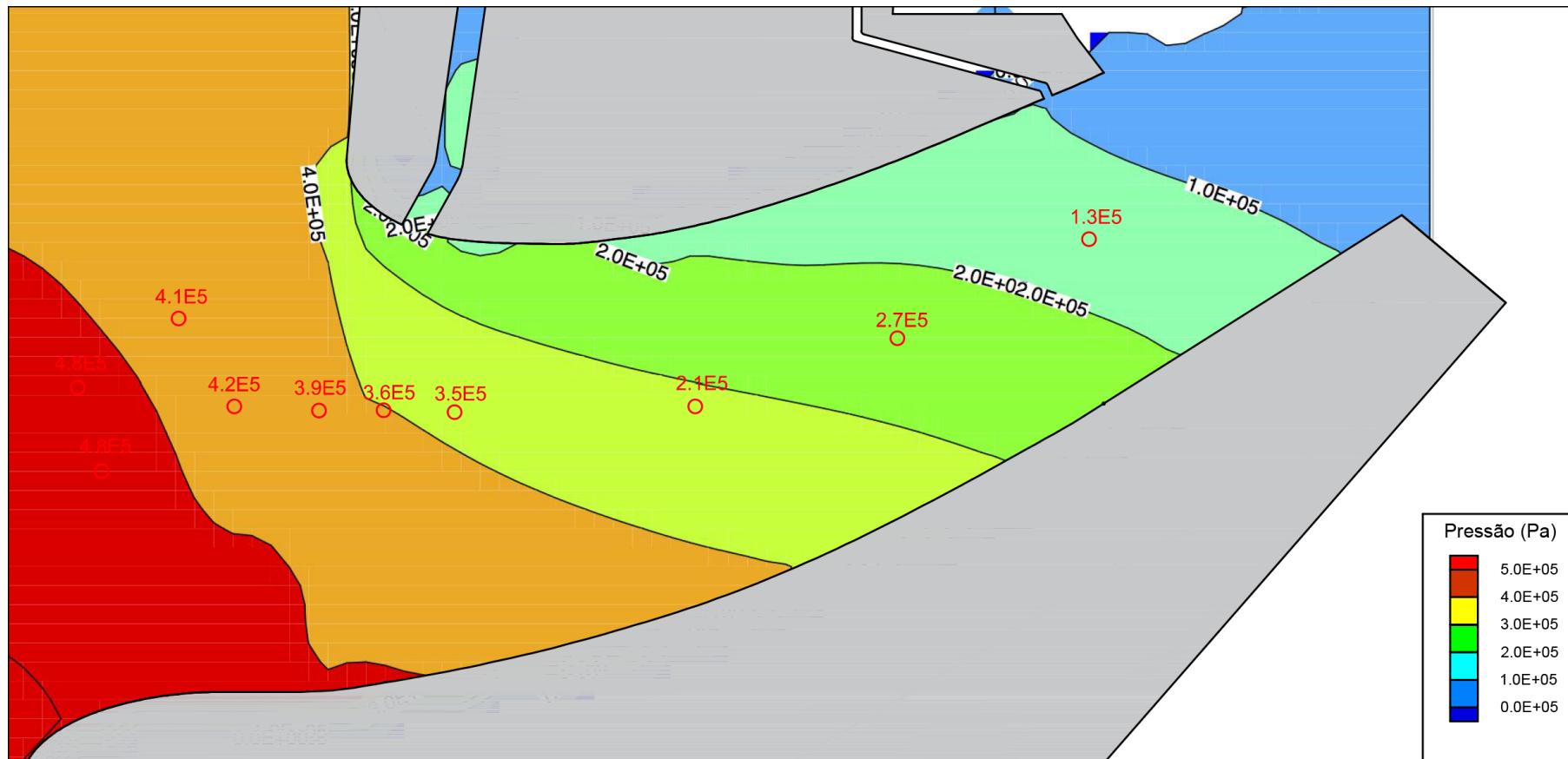
Figura 79 – Comparação dos resultados numéricos e experimentais (a vermelho) para H=295\text{m} - perfil lateral
