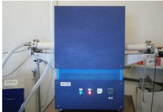
Fig. 44: Forno horizontal Termolab.
