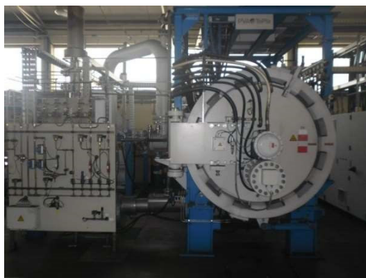
Fig. 43: Forno Sinter-HIP PVA TePla.
