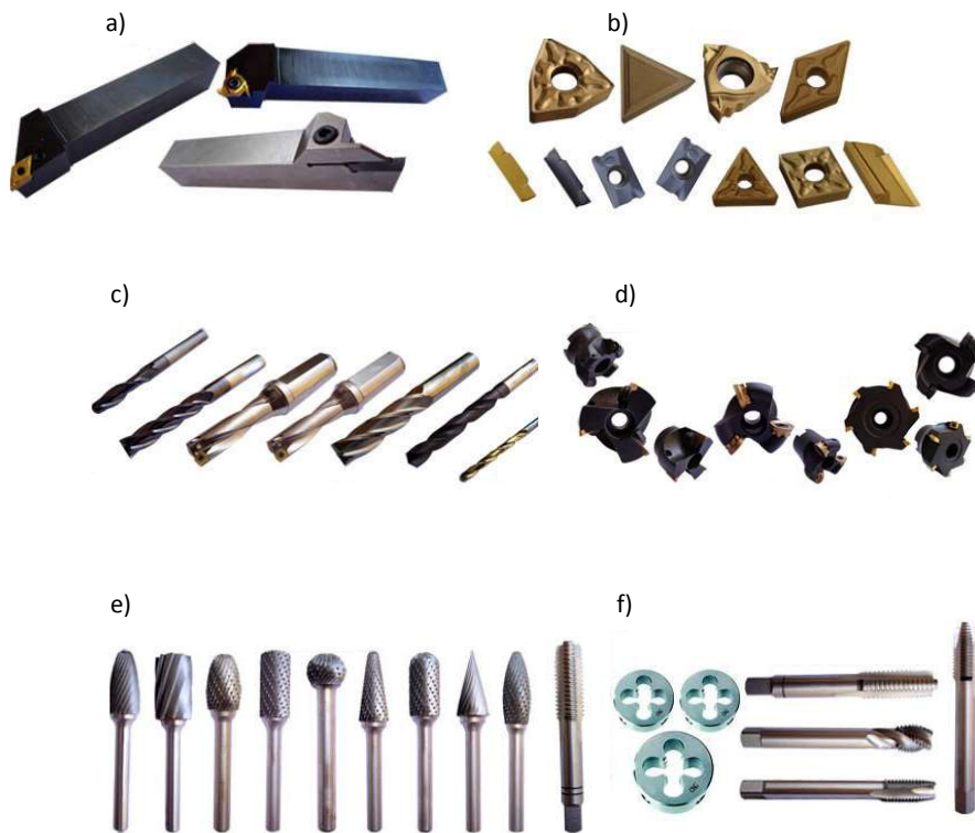
Fig. 9: Exemplos de ferramentas usadas em maquinação: a) ferros de torno com pastilhas intercambiáveis de WC-Co; b) pastilhas de WC-Co usadas em torneamento, fresagem, roscagem e sangramento; c) brocas com pastilhas intercambiáveis de WC-Co e brocas em HSS; d) fresas com pastilhas intercambiáveis de WC-Co e) limas com pontas de material abrasivo e f) machos e fêmeas.
