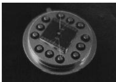
Figura 1.26 Fotografia de sensor resistivo de \text{SnO}_2 depositado por serigrafia produzido por Vincenzi et alia (Vincenzi et al., 2001).
