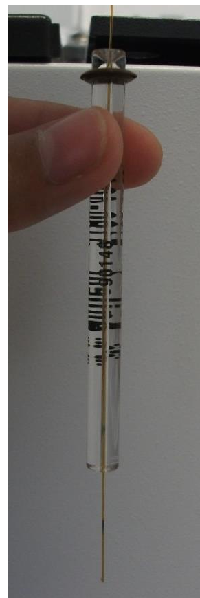
Figura 27 Remoção, com auxílio de um fragmento de coluna, de resíduos de septo que ficaram retidos no liner após utilização repetida do sistema GC-FID.
