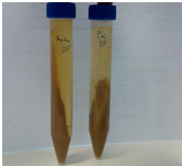
Figura 32 Separação das diferentes fases do retentato pré (tubo da esquerda) e pós-diafiltração (tubo da direita) sujeito a uma centrifugação a 4185g durante 10 minutos.
