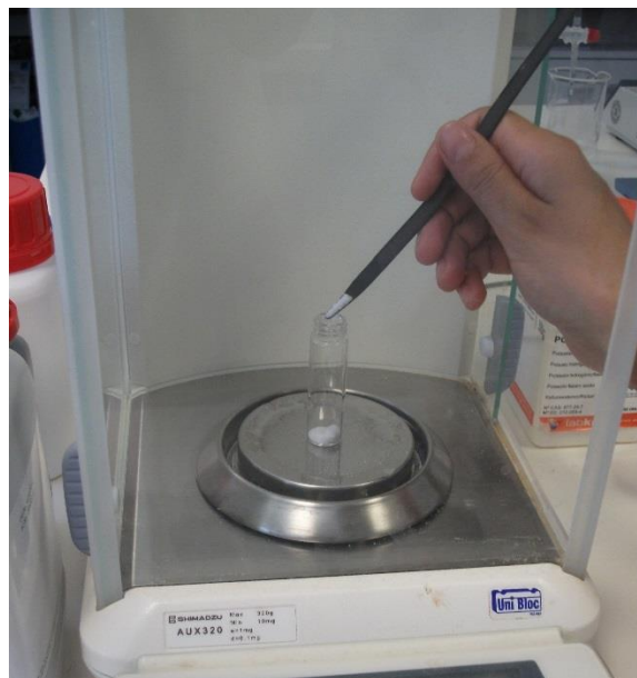
Figura 23 Preparação do frasco para extração de compostos voláteis.
