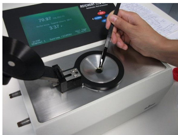
Figura 19 Espalhamento da amostra de sumo concentrado no poço do refratómetro para medição do °brix
