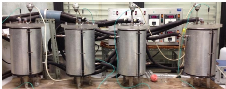
Figura 16: Vista frontal dos quatro reatores de compostagem da instalação.
