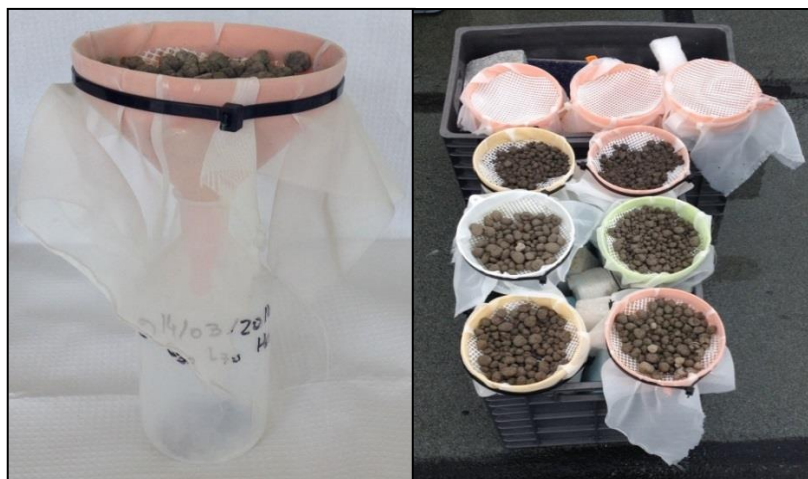
Figura 14: Exemplo de montagem para exposição de grânulos e brancos às condições atmosféricas.
