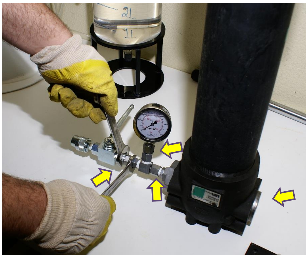
Figura 2 Verifica sempre o estado de aperto das porcas indicadas na figura pelas setas amarelas.
