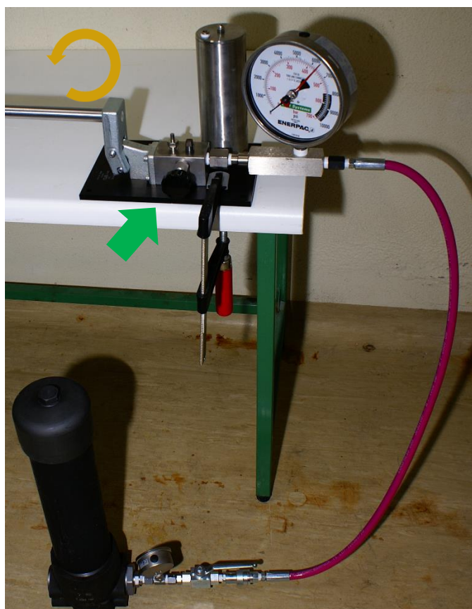
Figura 8 Sistema após despressurização. Mangueira pronta a ser retirada, repare que o manómetro indica pressão 0 na mangueira
