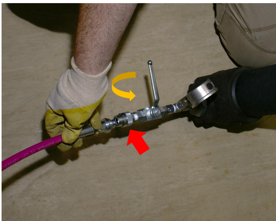
Figura 6 Encaixe da mangueira na CH. A seta vermelha indica a peça utilizada para enroscar a mangueira
