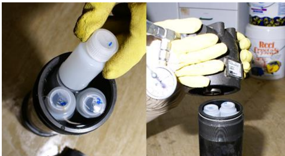
Figura 4 Colocação dos frascos na CH e fecho da mesma
