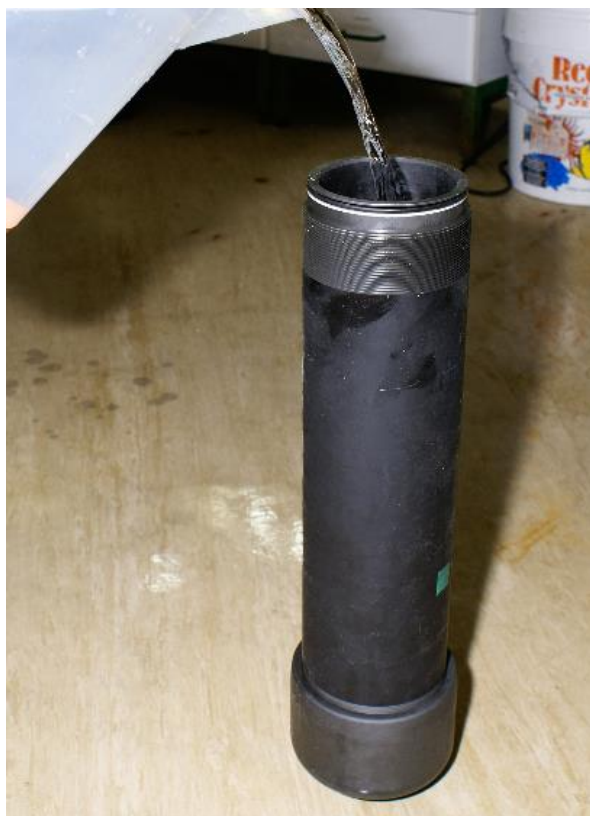
Figura 3 Enchimento da CH com água de osmose
