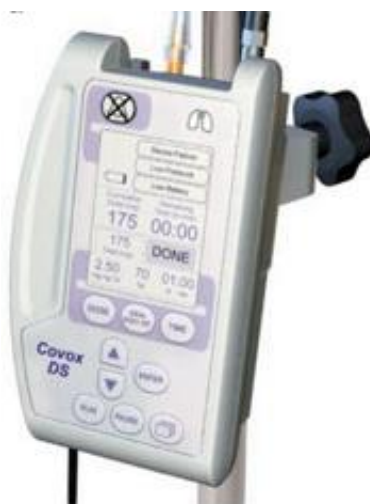
Figura 5: Aparelho desenvolvido especificamente para terapia com monóxido de carbono por inalação, aparelho de distribuição Covox DS desenvolvido por Ikaria.
