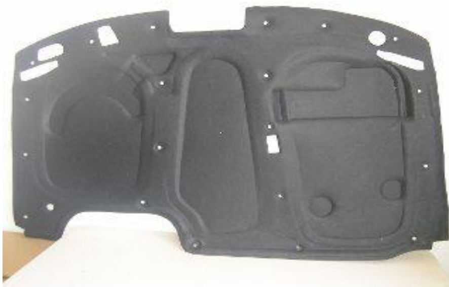
Figura 1.2: Forro de Isolamento do Capot Gol E Parati G3, E Versão Gti G3 (Mercado Livre)
