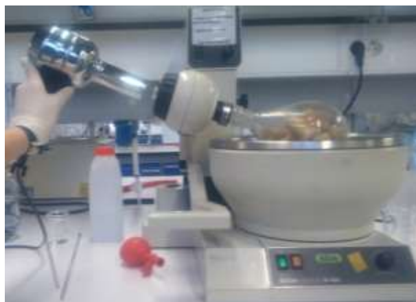
Figura 2.8- Equipamento utilizado no ensaio aplicando ácido peracético com ar forçado.
