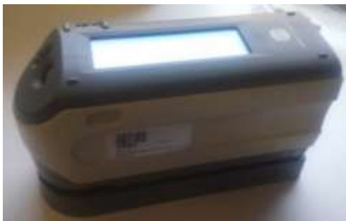
Figura 2.3- Colorímetro CM-2300d utilizado para medir a brancura ISO.
