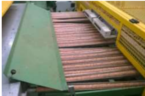
Figura 1.9- Bastões de cortiça formados após o processo de extrusão.
