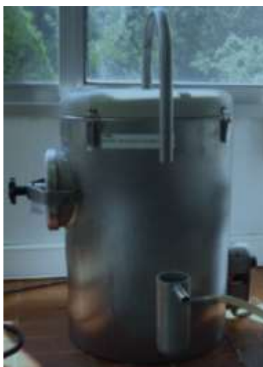
Figura 2.5- Aparelho utilizado para realizar a reversão da brancura.
