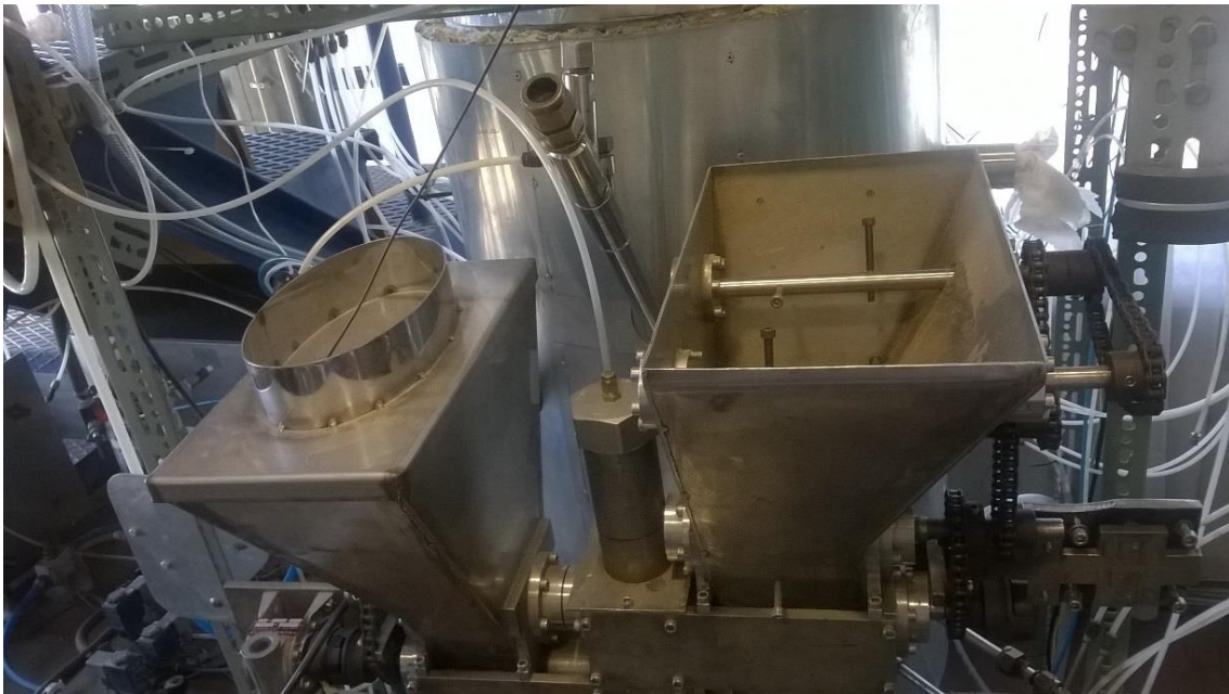
Figura 8- Sistema de alimentação da instalação experimental à escala piloto.
