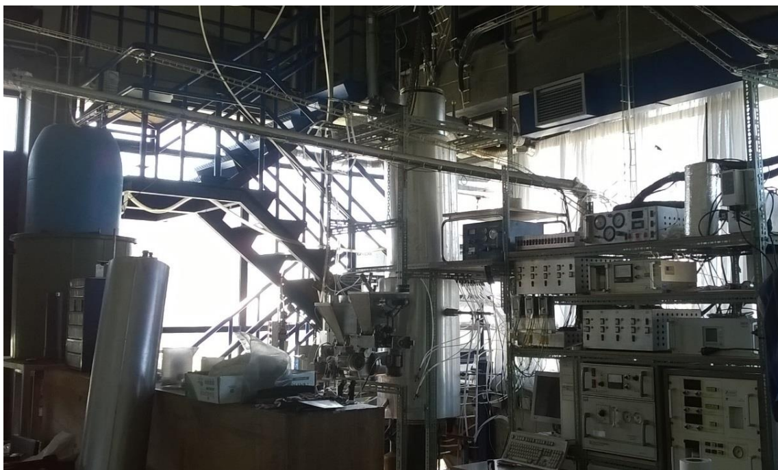
Figura 6- Instalação experimental de combustão de biomassa em leito fluidizado à escala piloto.
