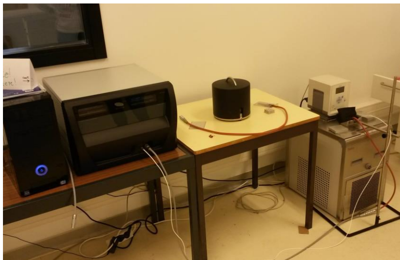
Fig. 14. Equipamento TPS 2500 S no Laboratório Térmico da UA.
