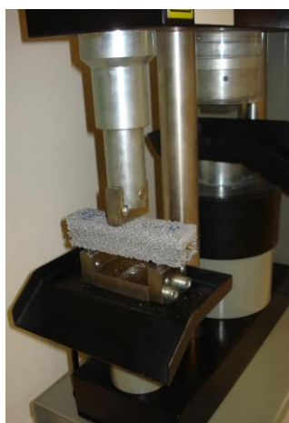
Fig. 11. Ensaio de flexão.
