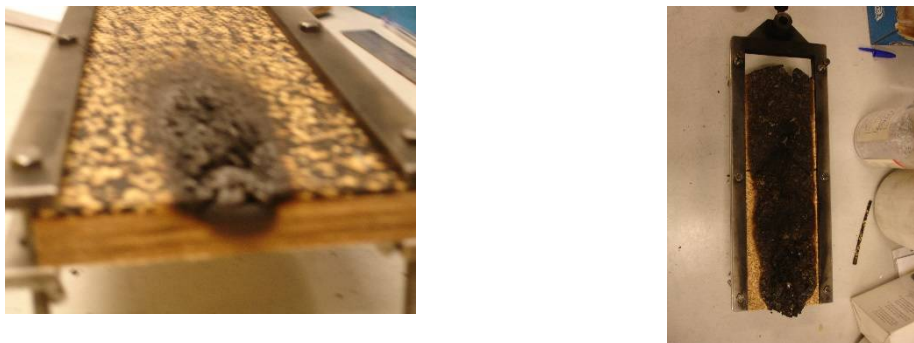
Figura 25-À direita: amostra com placa de plywood; à esquerda: Resultado final da amostra 20 sem plywood
