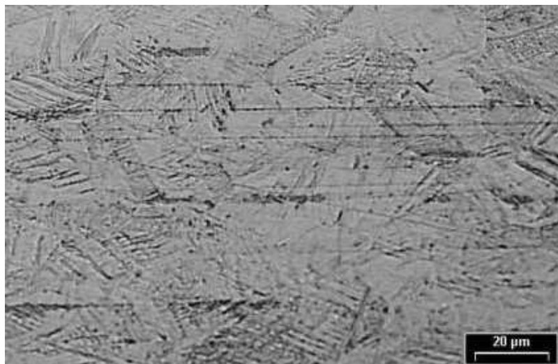
Figura 17. Fase do aço inoxidável AISI 304 depois da ruptura observada para a velocidade de deformação 1,1 \times 10^{-1} \text{ s}^{-1} .
