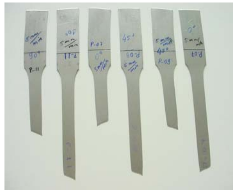
Figura 2. Provetes de aço inoxidável AISI 304 deformados a 0°, 45° e 90° em relação à direcção de laminagem até à ruptura.
