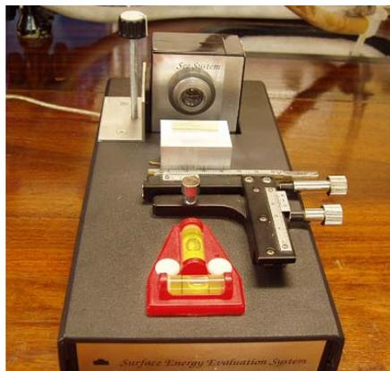
**Figura 22** – Fotografia do equipamento usado na medição dos ângulos de contacto das amostras.
