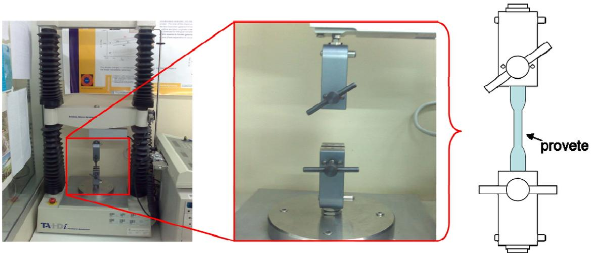
**Figura 24** - Fotografias do texturómetro e representação esquemática da montagem utilizada para os ensaios de tracção.
