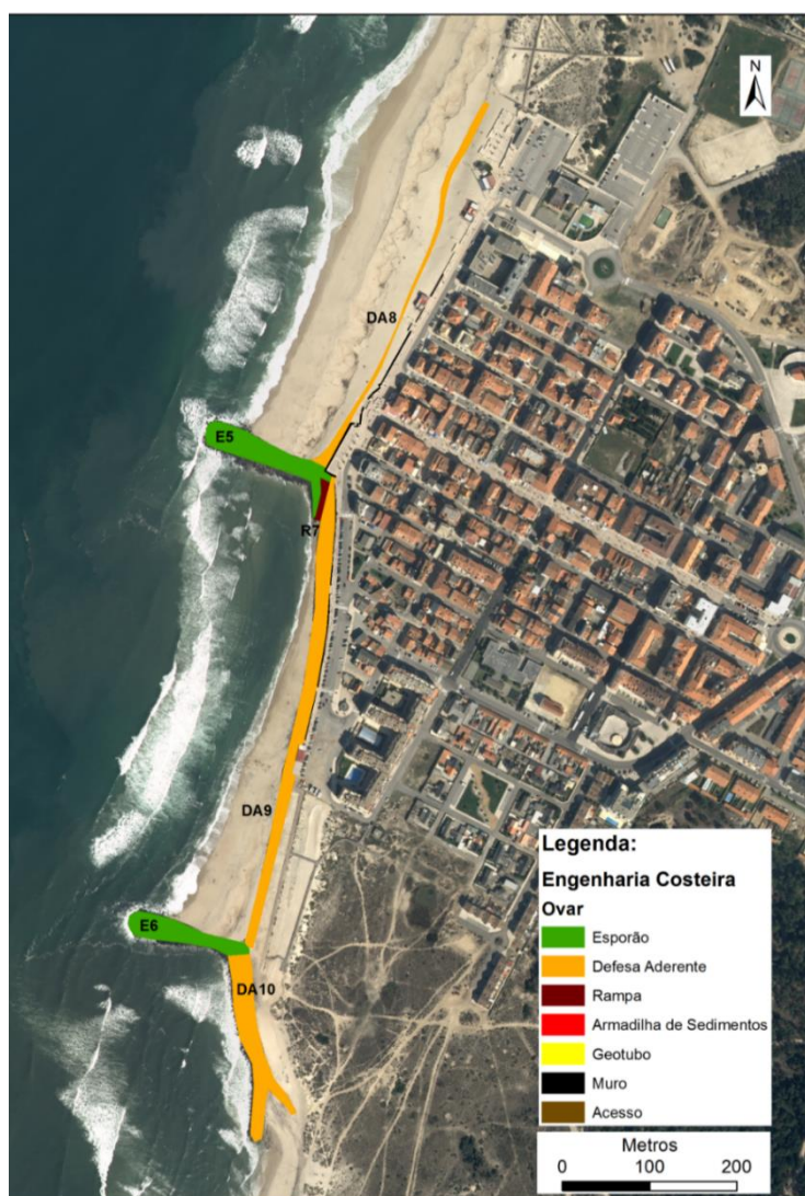
Figura 14 – Representação da praia do Furadouro, bem como a localização das respetivas obras de defesa costeira que a constituem (Fonte: DA-CMO, 6 de Março de 2015). Nota: Fotografia aérea de 2012.
