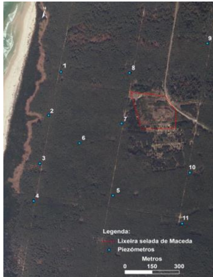
Figura 16 – Zona da lixeira selada de Maceda, com a distribuição dos piezómetros utilizados para análises feitas às águas subterrâneas (Fonte: Silva, 2012 adaptado de Ramalho e Ferreira, 1991).
