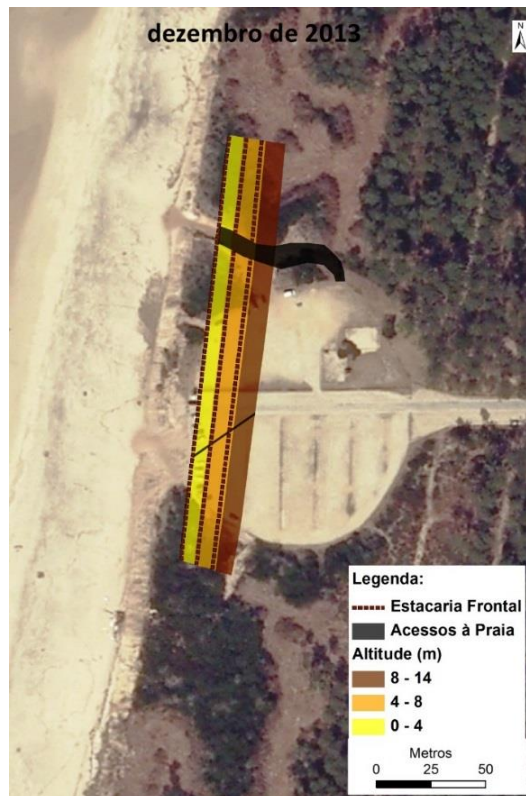
Figura 13 – Representação da praia de S. Pedro de Maceda, bem como a localização das respetivas obras de defesa costeira que a constituem, nomeadamente Contenção por Estacaria Frontal, desenvolvida em Dezembro de 2013 (Fonte: DA-CMO, 6 de Março de 2015). Nota: Fotografia aérea de 2010.
