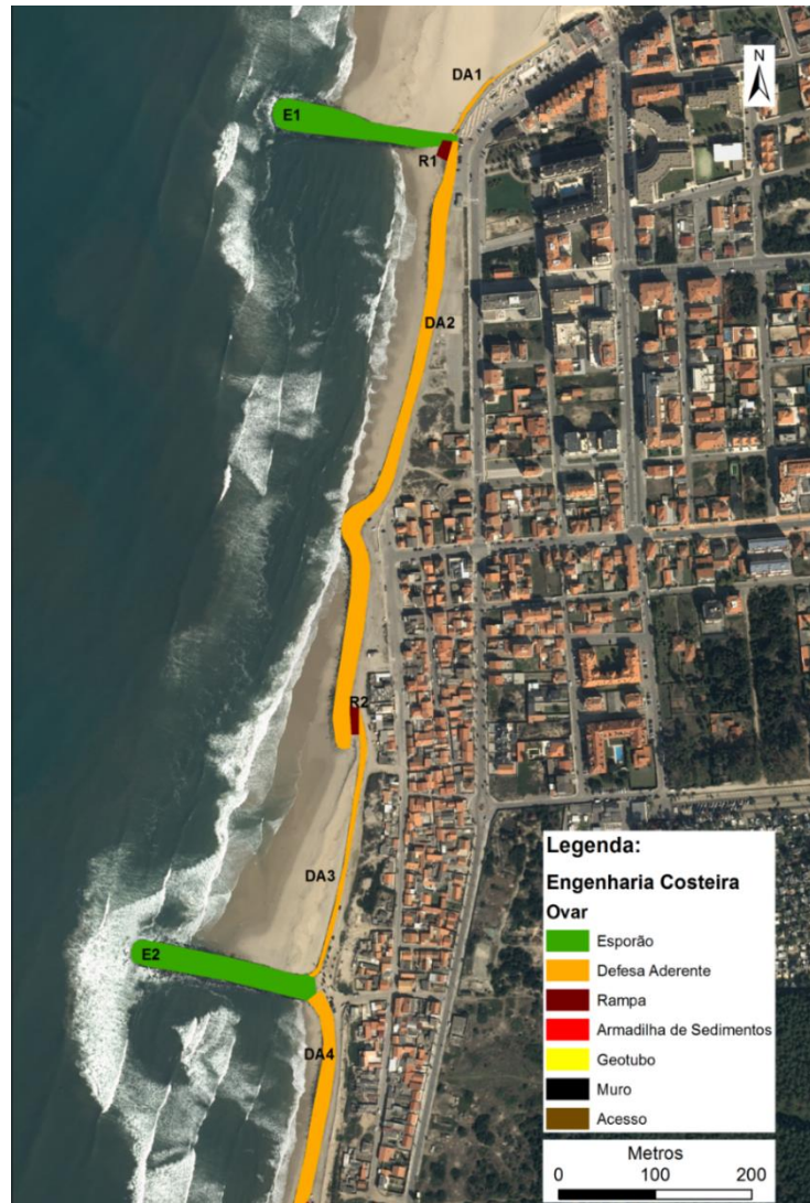
Figura 11 – Representação da praia de Esmoriz, bem como a localização das respetivas obras de defesa costeira que a constituem (Fonte: DA-CMO, 6 de Março de 2015). Nota: Fotografia aérea de 2012.
