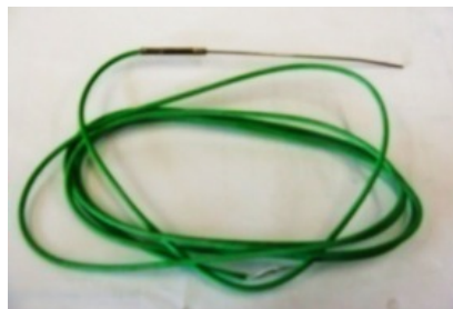
Figura 3.7 – Tipo de termopar K, utilizado no trabalho.
