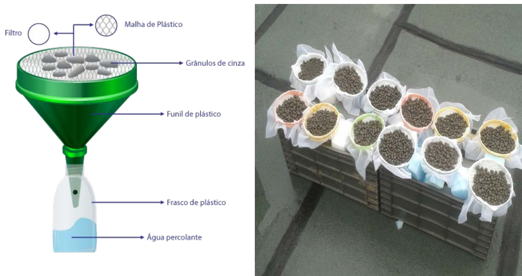
Figura 7: Preparação da montagem para a colocação dos grânulos de cinza à chuva
