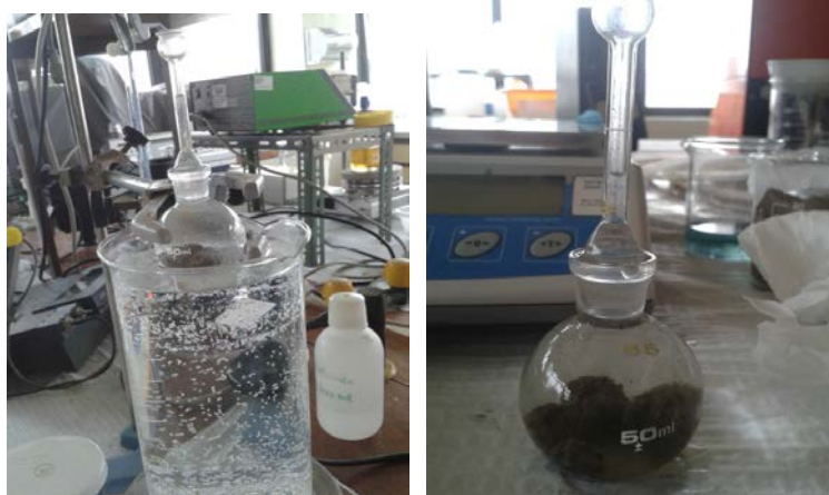
Figura 10: Procedimento realizado para obter a densidade real com recurso a um picnómetro
