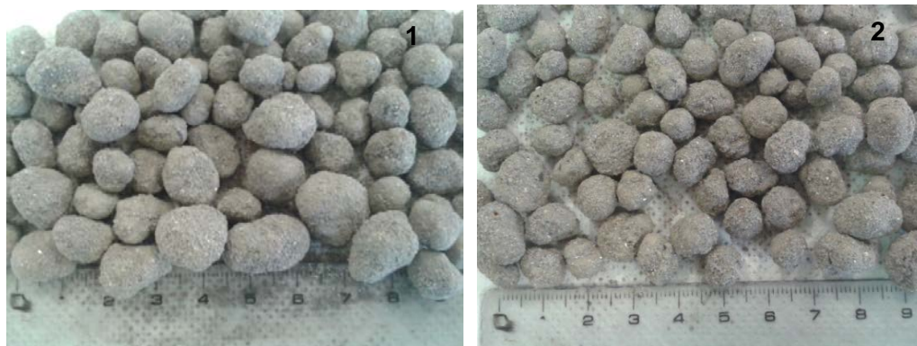
Figura 12: CV COM_20%_G2 expostos às condições meteorológicas- antes (1); após (2)
