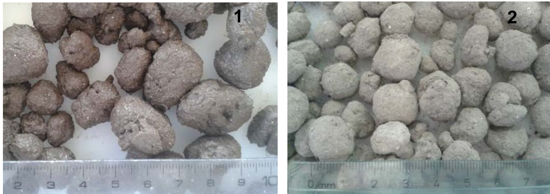
Figura 25: Grânulos C 60 _L 40 _H 57 no início do processo de formação (1) e passado um mês (2)
