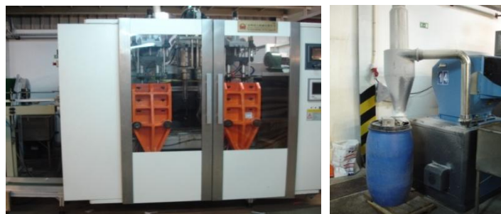
Figura 19. Máquina de produção de vasilhames PP, e moinho para trituração de rebarbas e embalagens de PP.
