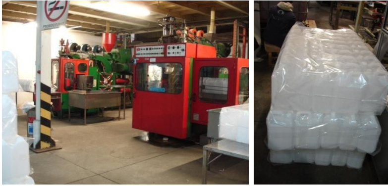
Figura 18: Da esquerda para a direita, máquina de produção de vasilhames de PE, e vasilhames de PE embalada para armazenamento.
