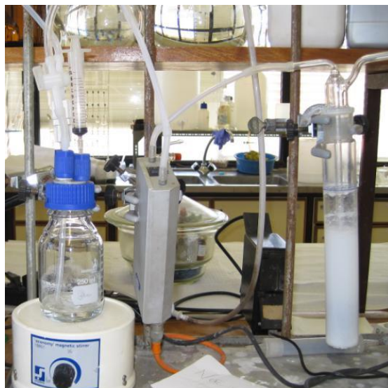
Figura 19 – Imagem da montagem experimental para determinação dos carbonatos, por reação com hidróxido de bário e titrimétria.
