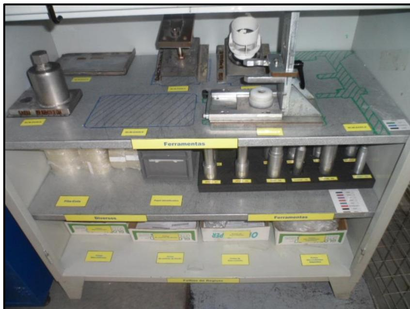
Figura 25 – Estado do posto da bancada da V2 após implementação dos 5S's
