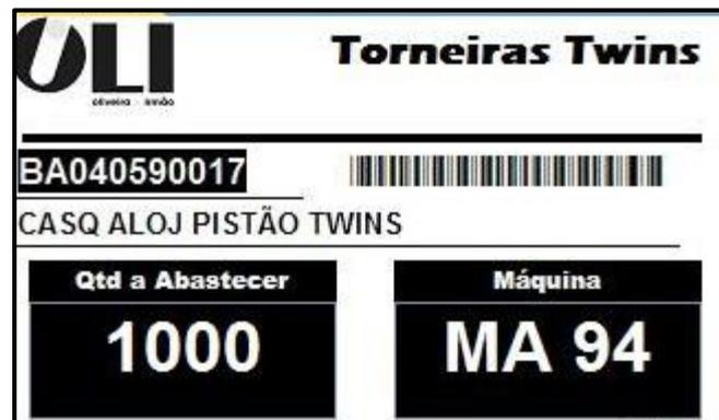
**Figura 12 – Exemplo de kanban utilizado na OLI**
