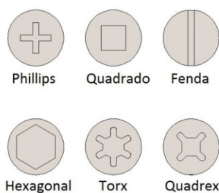
Figura 47– Entalhes dos parafusos (Silvestre et al, 2013).
