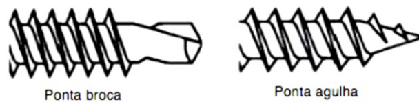
Figura 84– Tipos de pontas usadas nos parafusos no sistema LSF (Elhajj, 2004).
