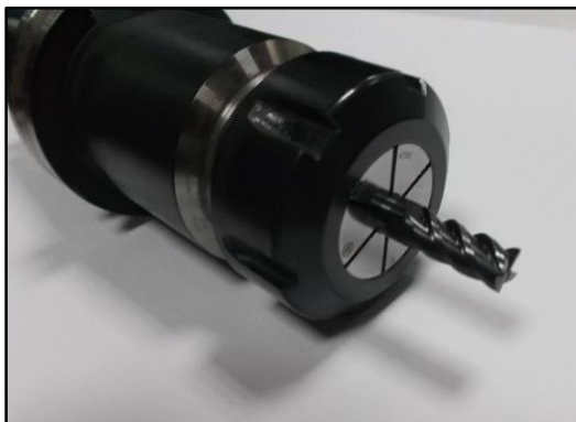
Figura 28: Exemplo de ferramenta apertada num cone simples
