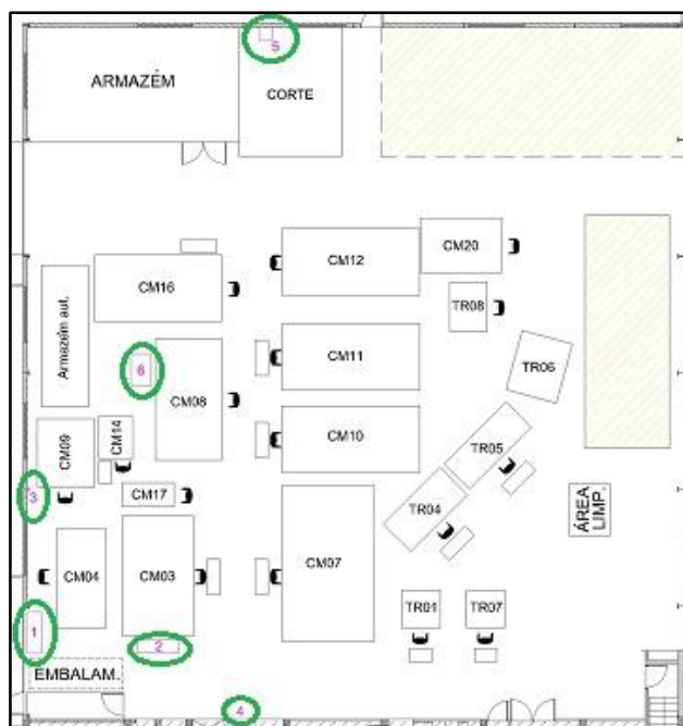
Figura 33: Localização inicial dos recursos necessários ao processo de montagem e troca de ferramenta
