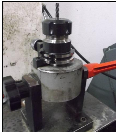
Figura 30: Suporte de aperto dos cones SK40
