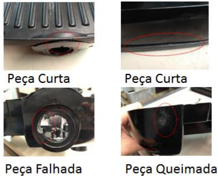
Figura 14 - Biblioteca de defeitos tabuleiro inferior
