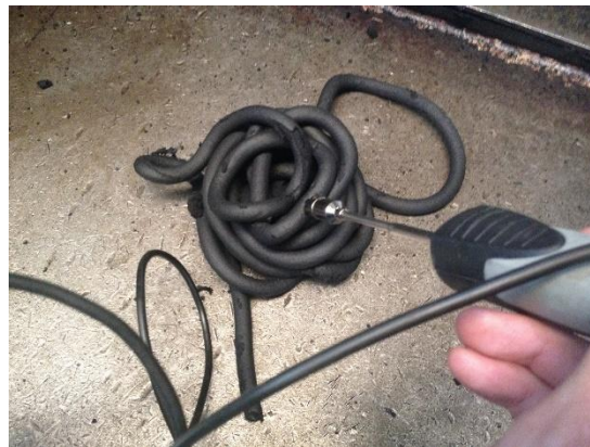
Figura 19 - Medição da temperatura da purga da matéria-prima para confirmar temperatura no bico da câmara
