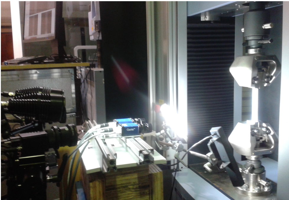
Figura 4.6: ARAMIS vs Sistema implementado.
