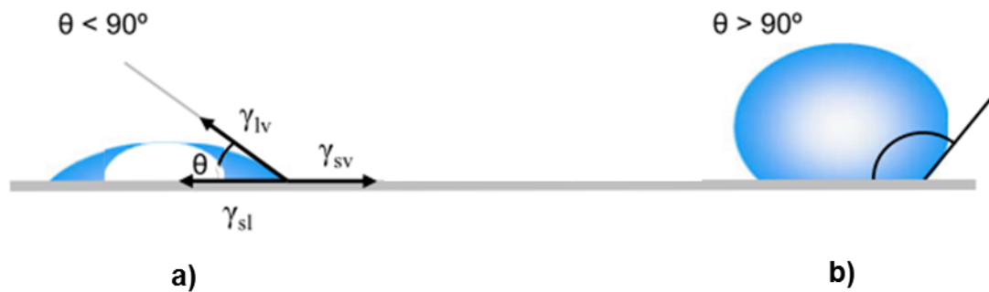
Figura 26- Ângulos de contacto formados em superfícies de materiais a) hidrofílicos e b) hidrofóbicos [adaptado de [127]].
