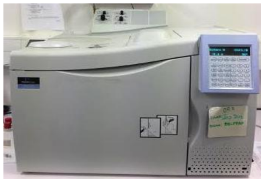
Figura 21 - Cromatógrafo de gás com detetor de ionização de chama (GC-FID).
