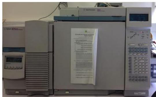
Figura 22 - Cromatógrafo de gás acoplado com espectrômetro de massa com quadropólo (GC-qMS).
