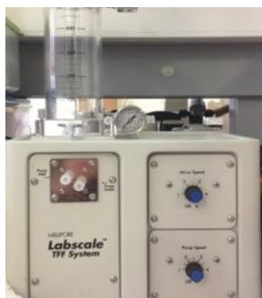
Figura 18 - Equipamento de ultrafiltração utilizado na extração dos polissacarídeos da salina da Universidade de Aveiro.
