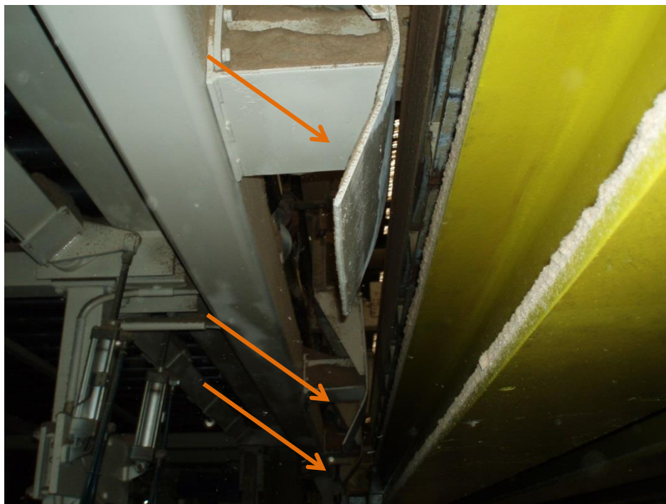
Figura 39 - Exemplo da inclinação da guia do despaletizador da linha de acabamento 2.
