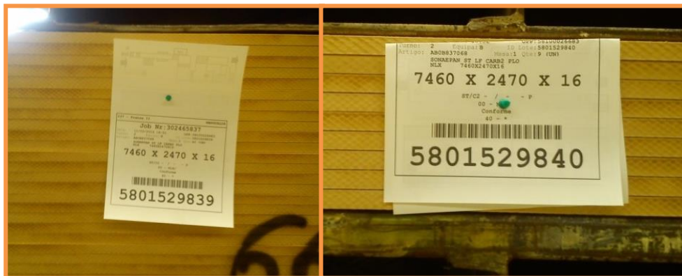
Figura 28 - Uso de pioneses para fixar a folha de palete.
