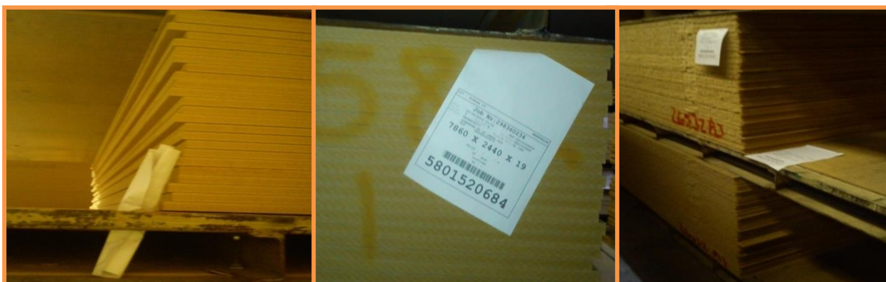
Figura 25 - Folhas mal colocadas na palete.
