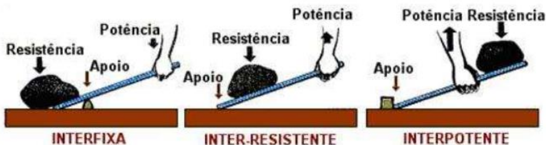
Figura 2 – Alavancas interfixas, inter-resistentes e interpotentes.
