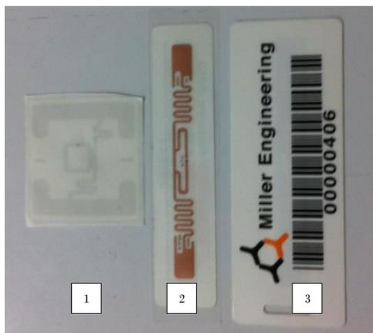
Figura 5.14: *Tags* utilizadas nas medições. 1-Smartrac; 2-IDSolutions; 3-Miller Engineering.
