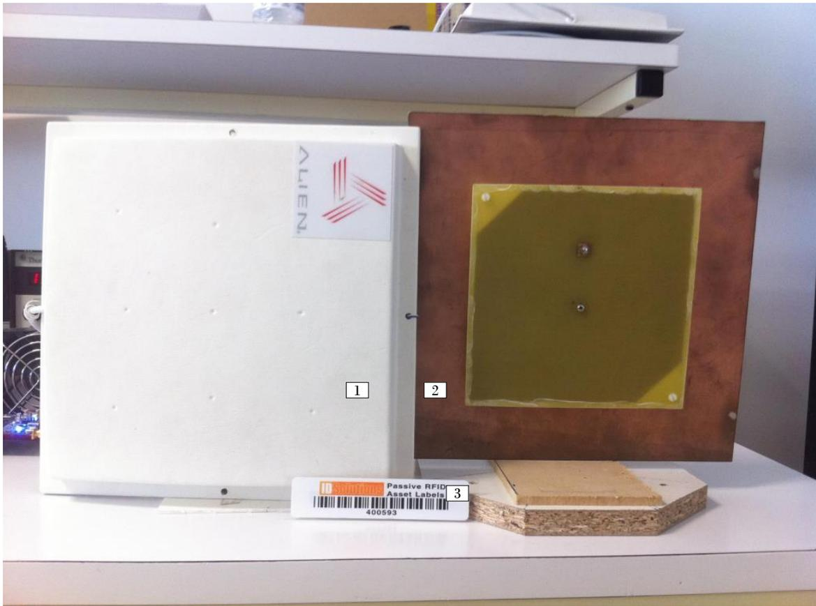
Figura B.3: Detalhe antenas de transmissão e recepção do Sistema Implementado. 1)Antena RX; 2)Antena TX; 3)Tag.
