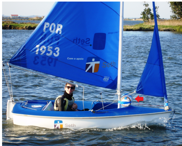
Figura 4.2: Módulo móvel completo aplicado ao barco de teste
