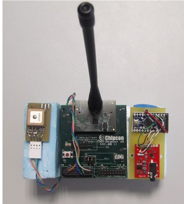
Figura B.3: Sistema dos optimists montado no molde de esferovite
