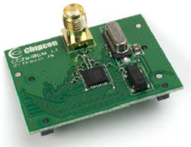
Figura 2.16: Módulo SoC CC1110F32 utilizado
