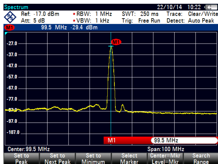
Figura 3.27: Frequência de operação observada no analisador de espectros para o TX
