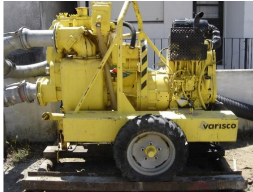
Figura 12 – Motobomba Centrífuga que integra o sistema de rebaixamento do nível freático
