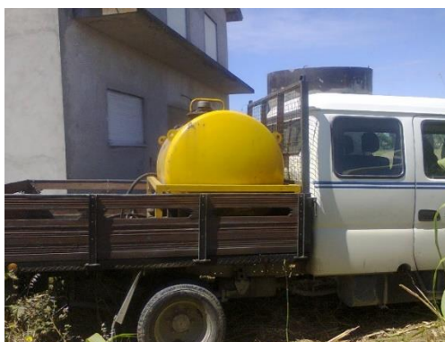
Figura 20 – Carrinha de apoio afeta à EE munida de um reservatório de combustível
