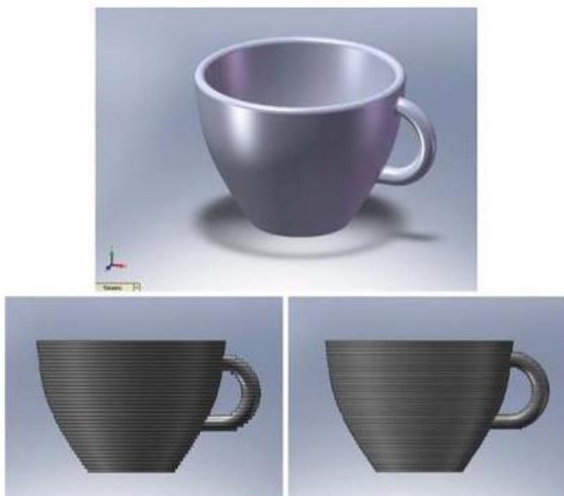
Figura 2: Imagem CAD de uma chávena, onde é visível a diferença de aspeto provocada por diferentes espessuras das camadas a depositar 3 .
