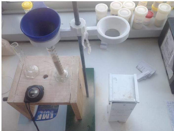
Figura 23: Sistema utilizado para realizar medidas de fluxo de escoabilidade e de fator de compactação.
