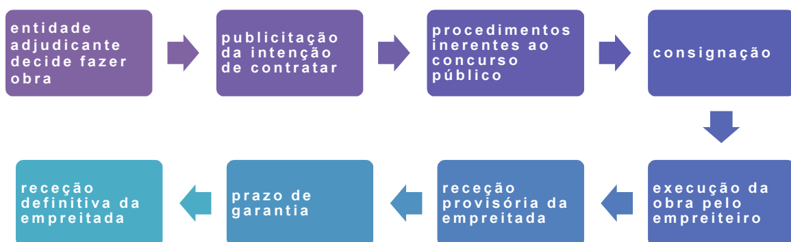
Figura 2 – Esquema geral do desenvolvimento da empreitada, desde a decisão de executar até obra concluída (Fonte: CCP)
