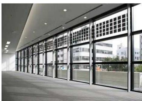
Figura 2.7: Integração em vão envidraçado do fabricante .[27]
