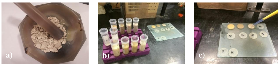
Figura 4.5 – a) Desagregação da amostra num almofariz de ágata; b) Tubos de ensaio com solução: amostra e água desionizada; c) Pipetagem da fração <2\mu\text{m} para as lâminas (fotografias da autora).
