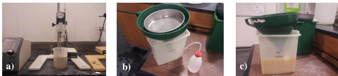
Figura 4.3 – a) Agitador mecânico; b) Conjunto balde, funil e peneiro 63 \mu m usado do processo de separação granulométrica via húmida; c) Balde com a fração <63 \mu m (fotografias da autora).
