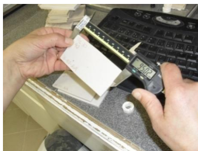
Figura 4.7 – Medição das pastilhas com o auxílio de um paquímetro (fotografia da autora).
