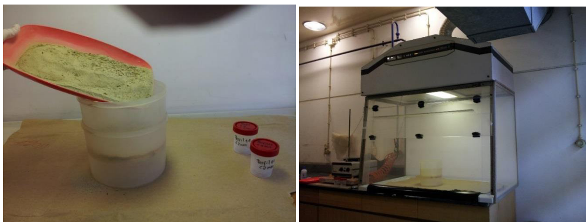
Figura 3.7 – Peneiramento das amostras de sedimentos de corrente: (a) utilizando um peneiro com uma malha de 2 mm; (b) Hotte utilizada durante a peneiração dos sedimentos.
