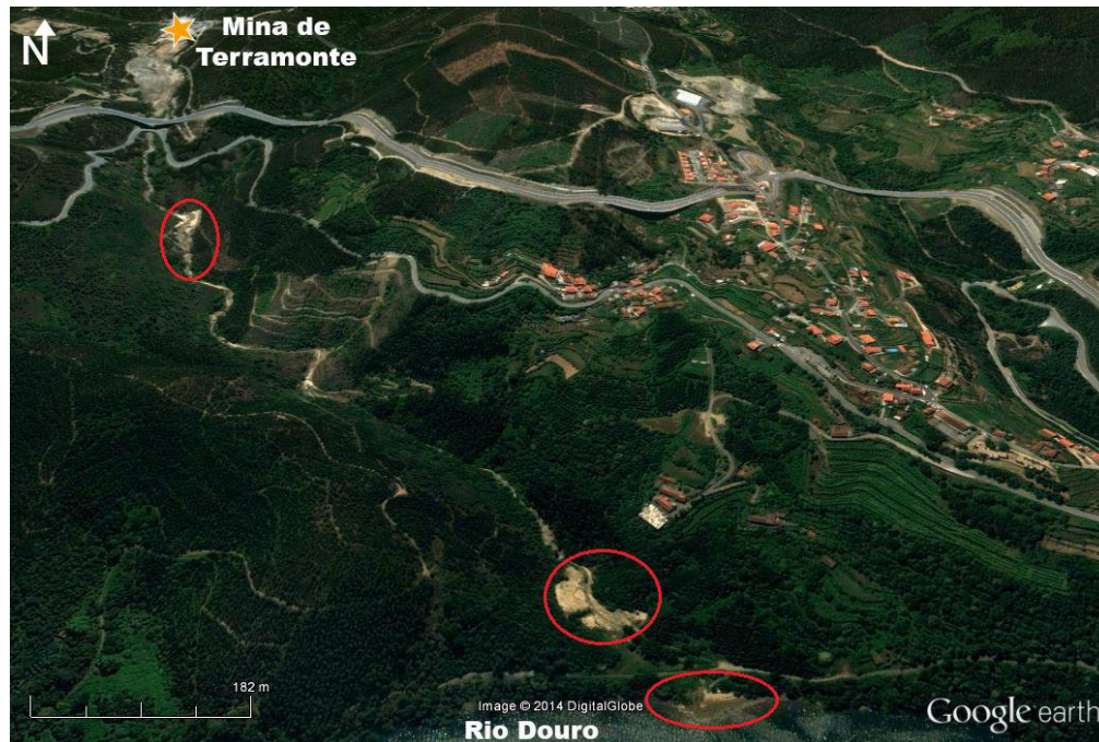
Figura 2.28 – Resíduos da escombreira (a vermelho) ao longo da ribeira da Castanheira e da margem esquerda do rio Douro (adaptado de www.googleearth.com , 2014).
