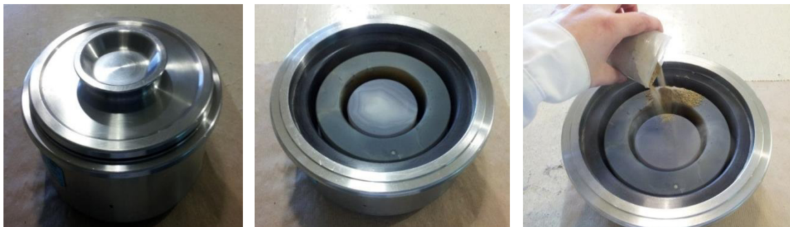
Figura 3.10 – Moinho de ágata e colocação da fração inferior a 2 mm no moinho de ágata.
