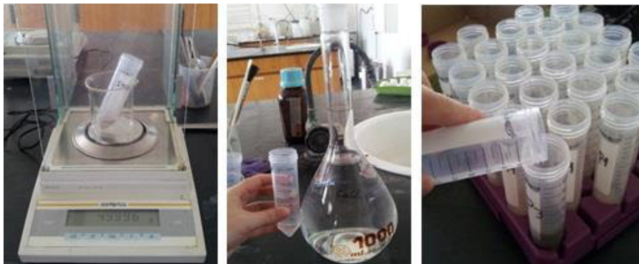
Figura 3.13 – Pesagem da amostra, medição do \text{CaCl}_2 , e adição do \text{CaCl}_2 à amostra para posterior medição do pH.
