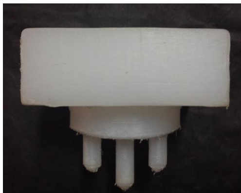
Figura 4-48 – Resultado da maquinagem da região inferior sem apoios
