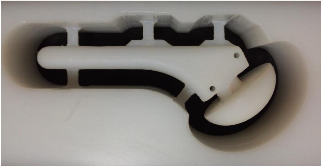
Figura 4-47 – Vista de topo da componente umeral com 5 apoios
