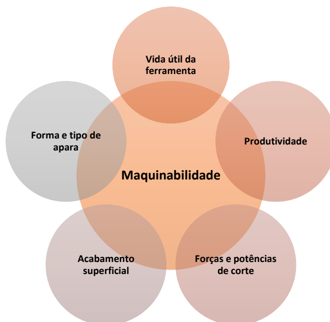
Figura 2-28 – Fatores que influenciam a maquinabilidade
