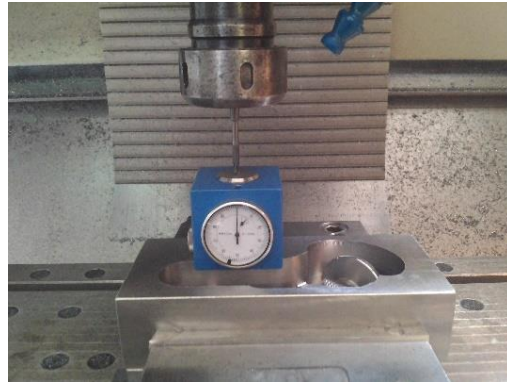
b) Determinação do zero-ferramenta
