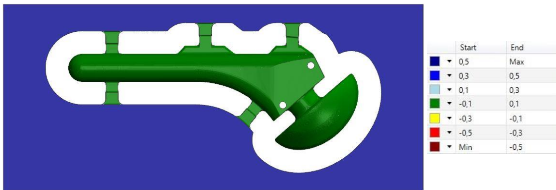
Figura A-1 – Resultado da aplicação da ferramenta Compare para a componente umeral
