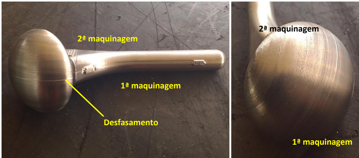
a) Desfasamento da maquinagem
