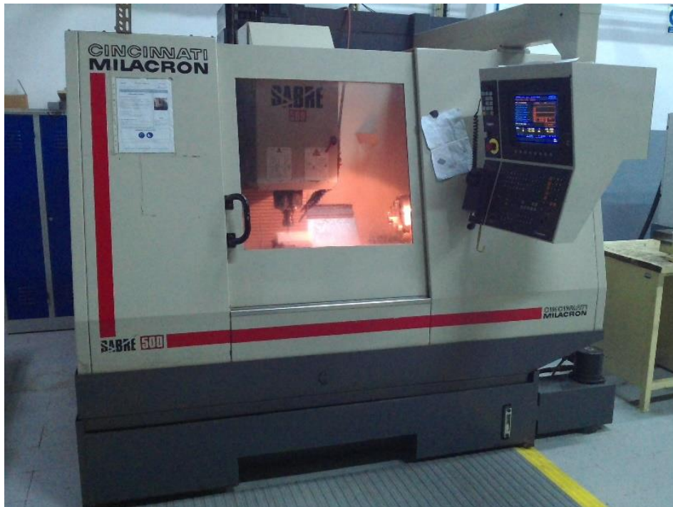
Figura 3-11 – Centro de maquinagem Cincinnati - Sabre 500 (cortesia CENFIM - Núcleo Oliveira de Azeméis)
