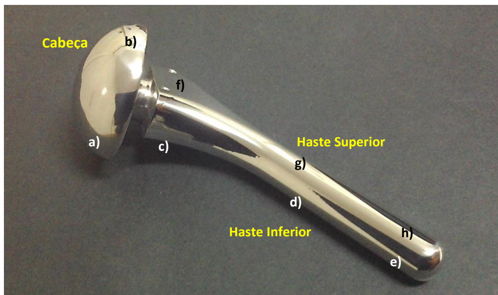
Figura 5-12 – Pontos para medição das rugosidades componente umeral
