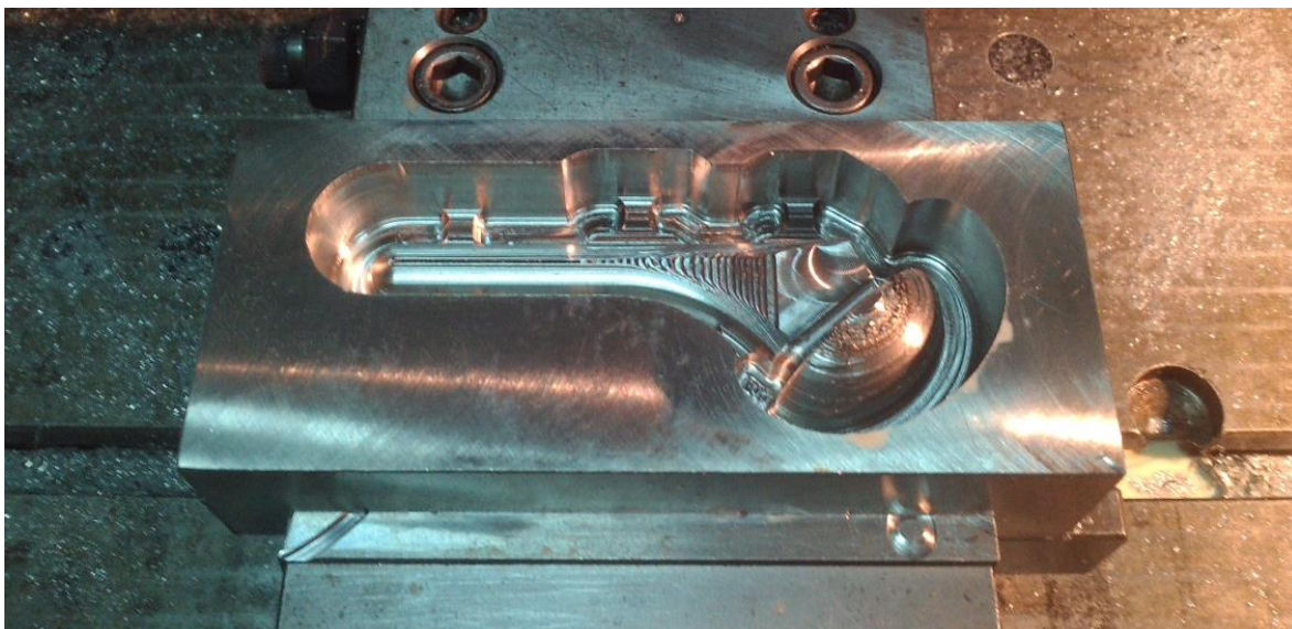
Figura 5-3 – Redesbaste com a estratégia Surface High Speed - Rest Roughing
