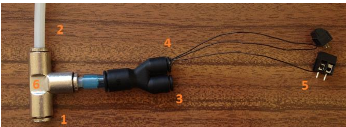
Figura 4.9 – Adaptação do caudalímetro ao sistema de ar comprimido.
