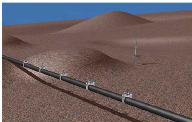
Figura 2.21 - Montagem típica no oceano. Esquema de comunicação entre CPS 's engatados ao longo dos vãos do gasoduto e da torre MSP . [13]
