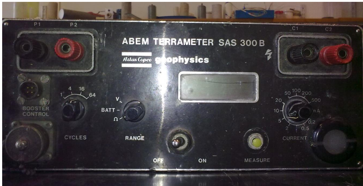
Figura 3.6 - Painel do resistivímetro ABEM Terrameter SAS 300 B.
