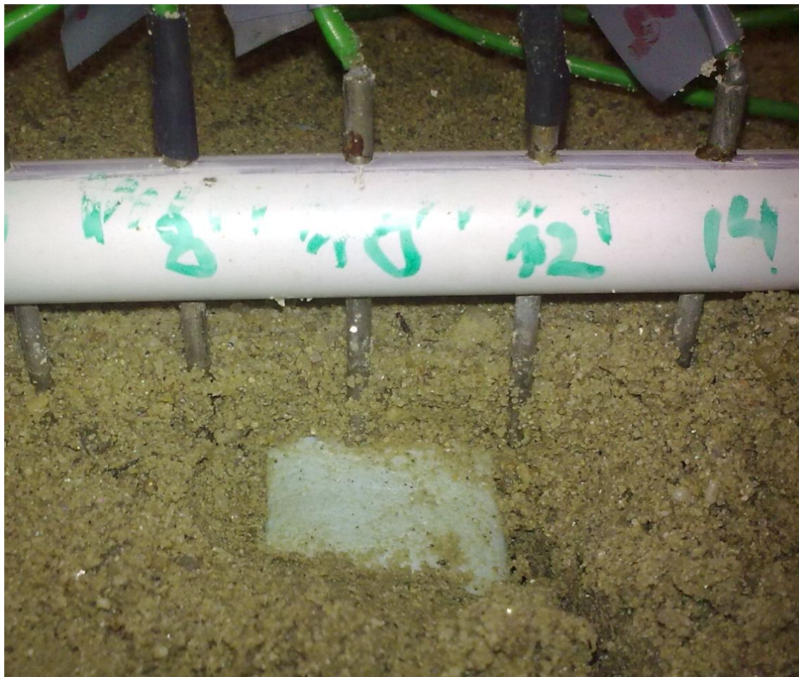
Figura 4.8 - Anomalia resistiva utilizada na fase de controlo (2D).
