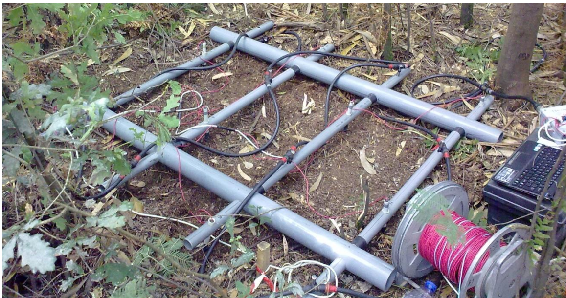
Figura 4.13 - Aspecto do sistema de aquisição em campo onde é possível visualizar vários componentes do sistema como os diferentes eléctrodos, caixa de controlo da posição de injeção, estrutura de suporte, uma bobine do eléctrodo no infinito (potencial) e o computador portátil.
