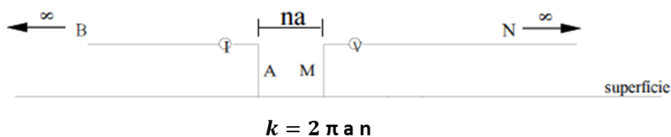
Figura 2.22 - Disposição dos electrodos para o arranjo polo-polo e o seu factor geométrico (adaptado de Gandolfo, 2007).
