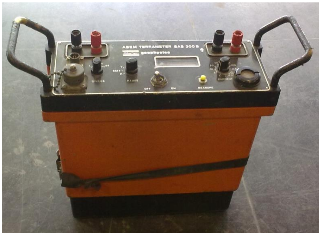
Figura 3.5 - Resistivímetro ABEM Terrameter SAS 300 B utilizado neste trabalho como fonte de corrente.
