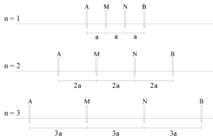
Figura 2.9 - Arranjo de Wenner para três níveis distintos (Gandolfo, 2007).
