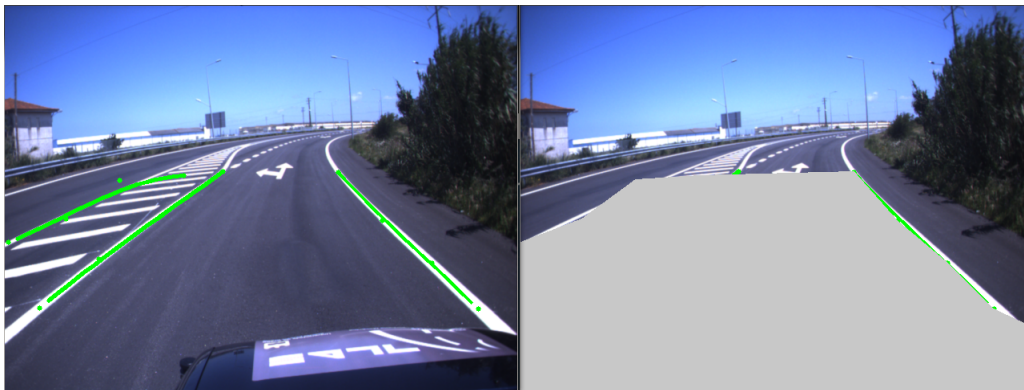
Figura 3.11: Polígono representativo do espaço navegável criado a partir das linhas da estrada.
