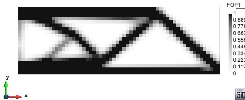
Figura 5.3: Viga bi-apoiada: ilustração do resultado de otimização topológica aplicado no problema.
