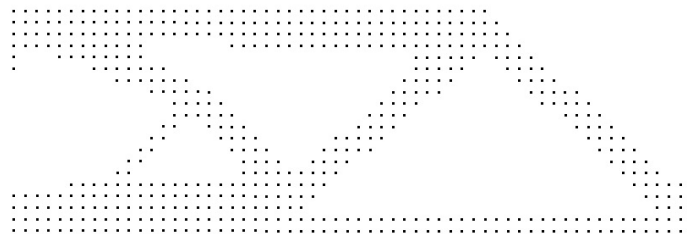
Figura 5.4: Viga bi-apoiada: nuvem de pontos no intervalo de densidades de [0,65;1] .
