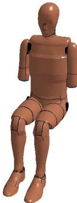
Figura 4.1: Dummy completo do modelo LSTC.ES-2.100208 V0.101.BETA [1].
