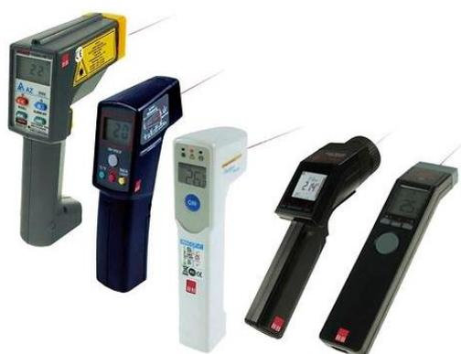
**Figura 3.1.5 - Pirómetros [17].**
