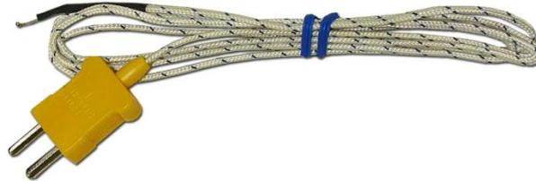
**Figura 3.1.2** - Termopar tipo K [12].
